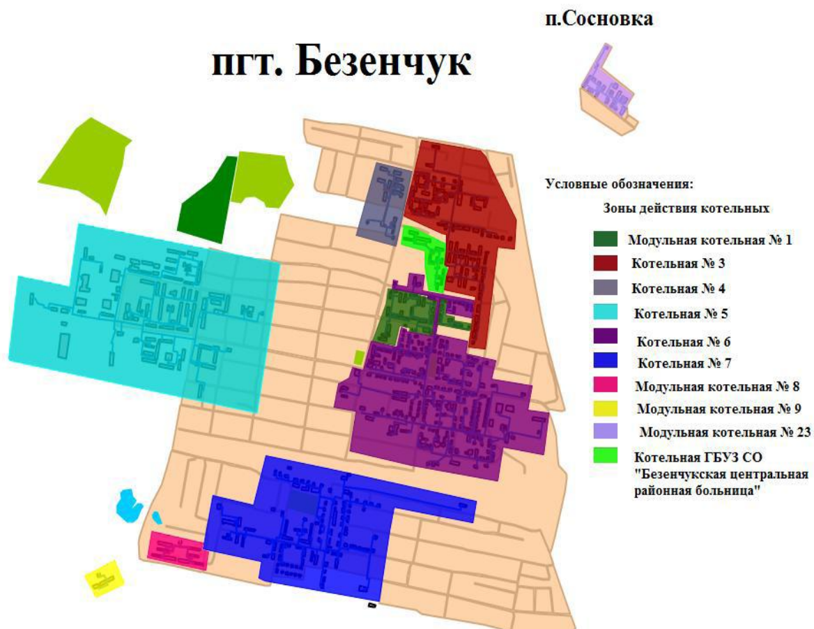
Рисунок 11 – Зоны действия автономной и централизованных котельных п.г.т. Безенчук и п. Сосновка
