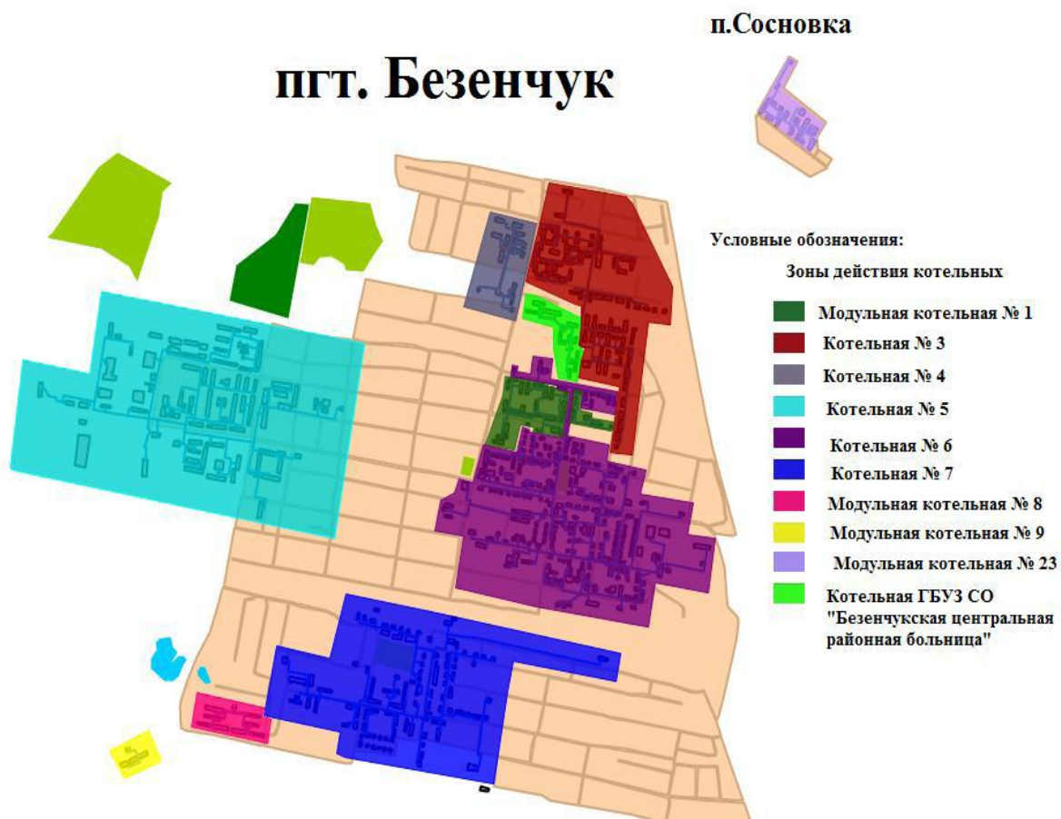
Рисунок 26 – Существующие зоны действия автономной и централизованных котельных п.г.т. Безенчук и п. Сосновка
